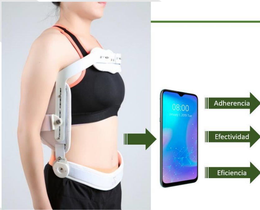
Imagen 1. Prototipo de sistema de monitorización integrado en un corsé para pectus carinatum.
