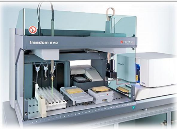
Robot TECAN®: robot pipeteador de líquidos
