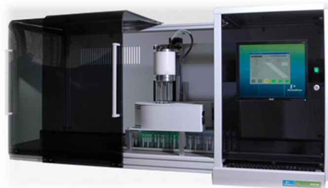
Robot CHEMAGEN®: robot extractor de ácidos nucleicos
